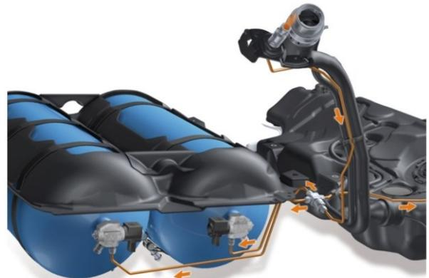
Réservoir en matériau composite (type cylindrique GNC-4) dans le coffre avec plaque de recouvrement enlevée
