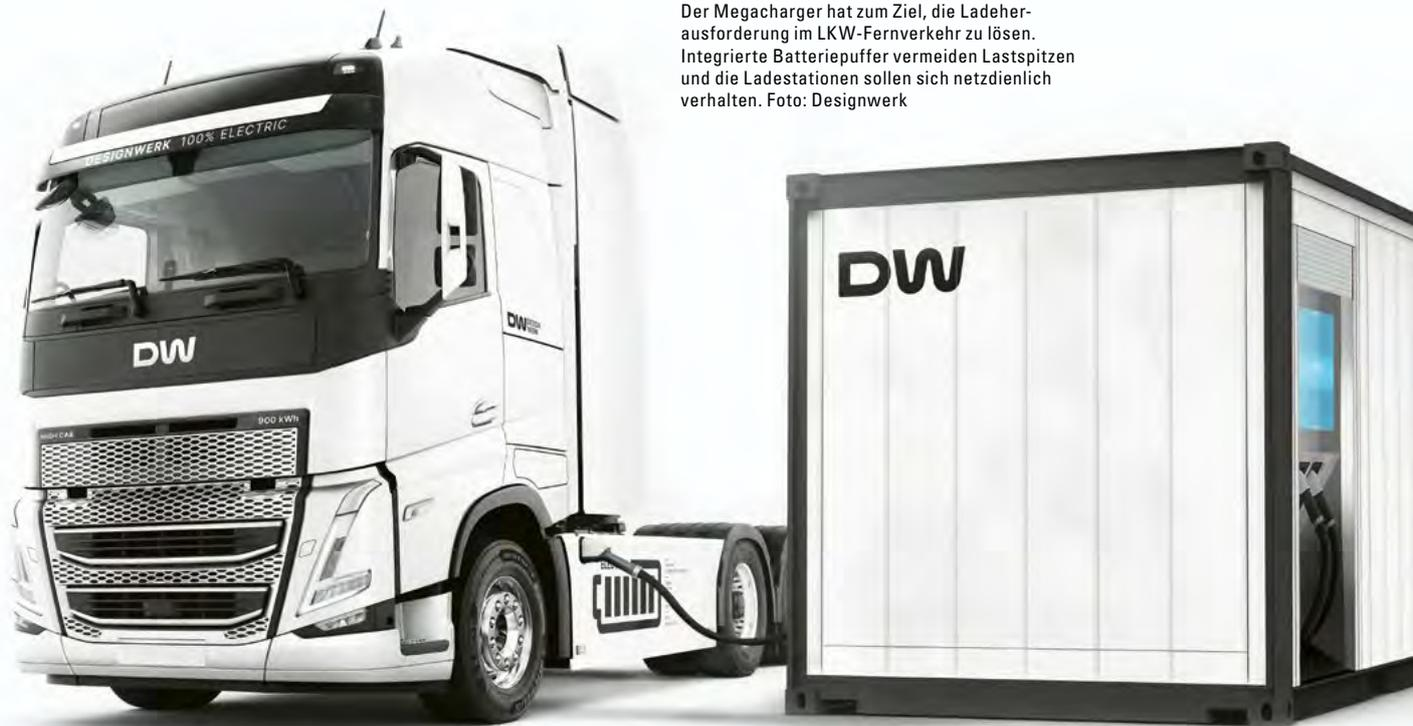
Der Megacharger hat zum Ziel, die Ladeherausforderung im LKW-Fernverkehr zu lösen. Integrierte Batteriepuffer vermeiden Lastspitzen und die Ladestationen sollen sich netzdienlich verhalten. Foto: Designwerk
