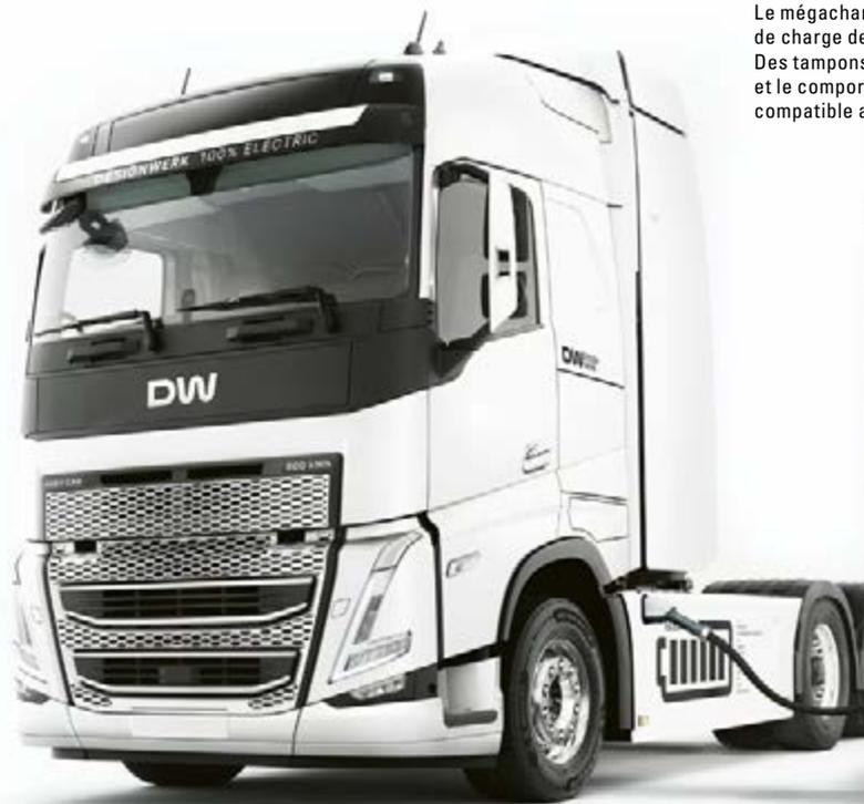
Le mégachargeur a été conçu pour résoudre les problèmes de charge de camions parcourant de longues distances. Des tampons de batterie intégrés évitent les pics de charge et le comportement des stations de recharge doit être compatible avec le réseau. Photo: Designwerk
