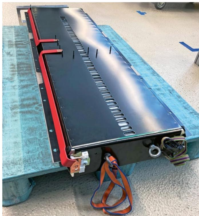
Von aussen sind die neuen Feststoffbatterien nicht von konventionellen Lithium-Ionen-Batterien zu unterscheiden. In der Konstruktion aber deutlich: Die Volumenänderung und die Arbeitstemperatur von rund 80° C sind aufwändig. Foto: BMW
