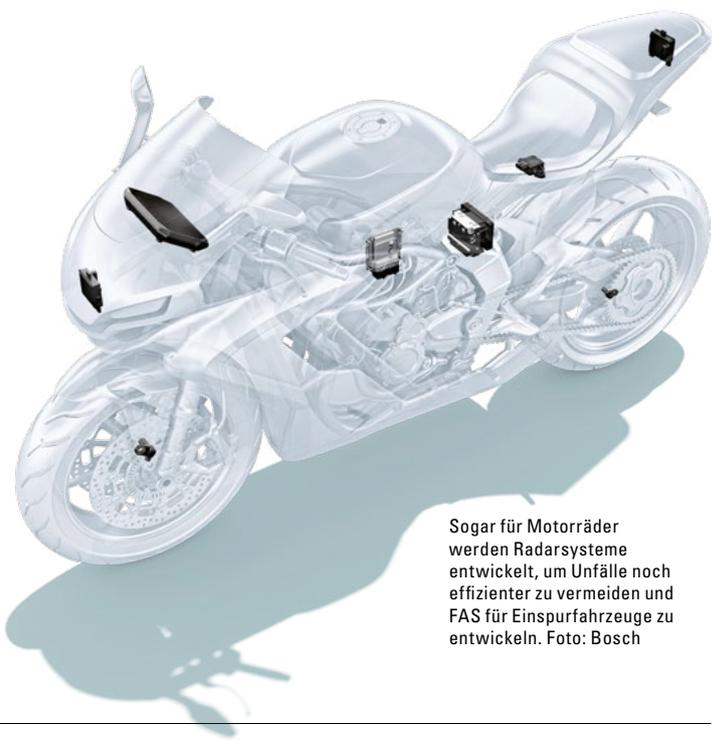
Sogar für Motorräder werden Radarsysteme entwickelt, um Unfälle noch effizienter zu vermeiden und FAS für Einspurfahrzeuge zu entwickeln. Foto: Bosch
