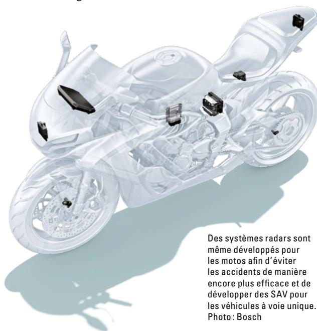
Des systèmes radars sont même développés pour les motos afin d'éviter les accidents de manière encore plus efficace et de développer des SAV pour les véhicules à voie unique. Photo : Bosch
