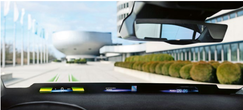
La prise en charge de la conduite par le véhicule et la restitution des commandes au conducteur nécessitent une logique claire et compréhensible. Des affichages tête haute ou d'autres techniques d'affichage y contribuent. Photo : BMW
