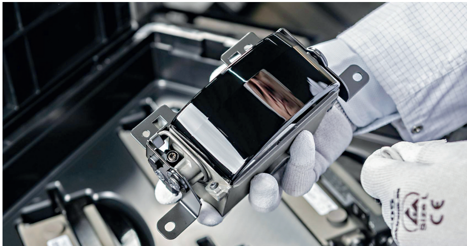
De petites caméras fish-eye sont requises pour générer des vues de l'environnement composées. Photo: Continental
