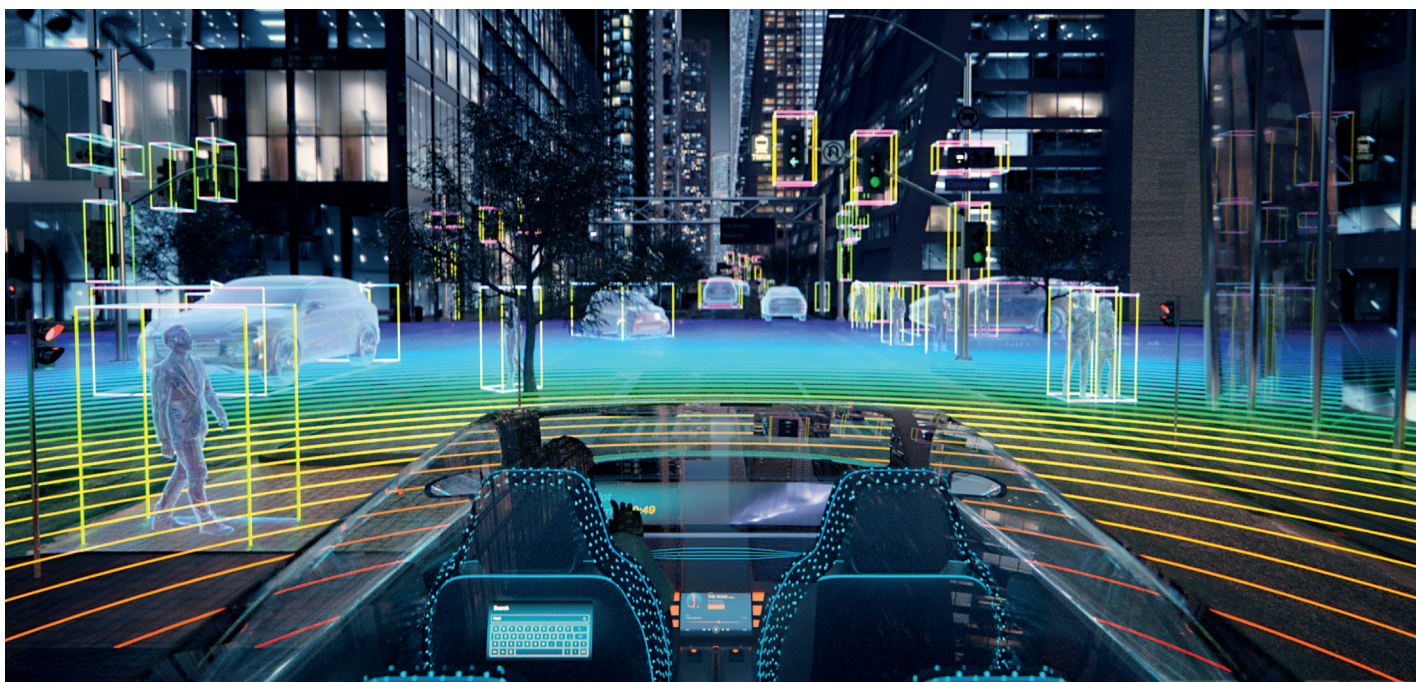
Les capteurs environnementaux et les images des caméras fusionnent pour former un environnement numérique. La machine appréhende la circulation de manière plus complète que l'homme. Photo : Osram
