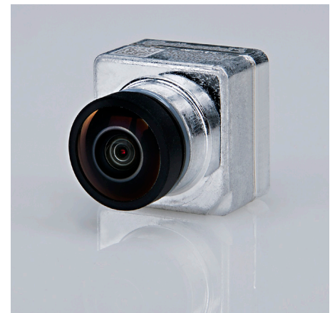
De petites caméras fish-eye sont requises pour générer des vues de l'environnement composées. Photo: Continental
