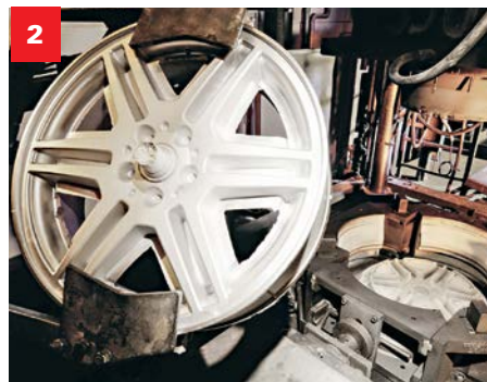
1 Um die Radmasse zu minimieren, wird bei hochwertigen Rädern das Flow Forming Verfahren eingesetzt. Dabei wird der aufgewärmte Gussrohling aufgespannt und mit einer hydraulisch angepressten Rolle wie ein Teig gedrückt. Das Felgenbett wird dabei gestreckt und das Material gleichzeitig verdichtet. Mit diesem Verfahren lassen sich Felgenbettdicken von rund 2,3mm wie bei geschmiedeten Rädern realisieren (Gussräder rund 5mm). 2 Im Massenmarkt werden die Aluminium-Leichtmetallräder im Niederdruckgussverfahren produziert. Die Rohlinge werden anschliessend weiterbearbeitet und lackiert. 3 Um die Sicherheit ab Werk zu garantieren, werden bei Premiumanbietern die Räder vollautomatisiert geröntgt, um Einschlüsse festzustellen. Billigräder werden oft nicht vom Hersteller geprüft und preisgünstigere Legierungen verwendet. Fotos: Ronal
