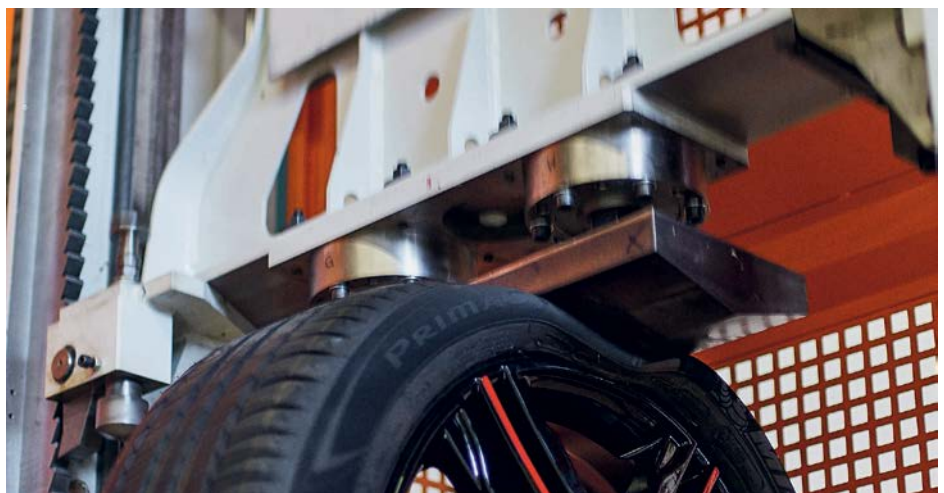
Festigkeitsanalyse in dynamischen Versuchen (oben) und im statischen Prüfverfahren: Radhersteller mit Renommee prüfen ihre Erzeugnisse in der Entwicklung auf Herz und Nieren, um den Kunden sicherheitstechnisch einwandfreie Räder zu verkaufen. Billiganbieter, die ihre Produkte im Internet zu enorm günstigen Preisen anbieten, verzichten sowohl auf die Qualitätssicherung in der Produktion als auch auf teure Entwicklungsverfahren. Um trotzdem die Festigkeit zu gewährleisten, werden dickere Wandbreiten gegossen und die Räder sind entsprechend deutlich schwerer. Fotos: Ronal
